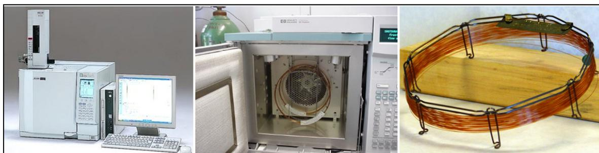
**Fig. 8b.** Cromatógrafo à Gás; **Fig.8c.** Forno do Cromatógrafo; **Fig.8d.** Coluna capilar de Sílica Fundida para Cromatógrafo à Gás.
