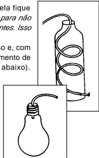
5 - Corte uma borracha escolar de modo que ela sirva de tampa para o balão. Faça um furo nesta tampa com o diâmetro igual ao da mangueira (observe a figura ao lado);
